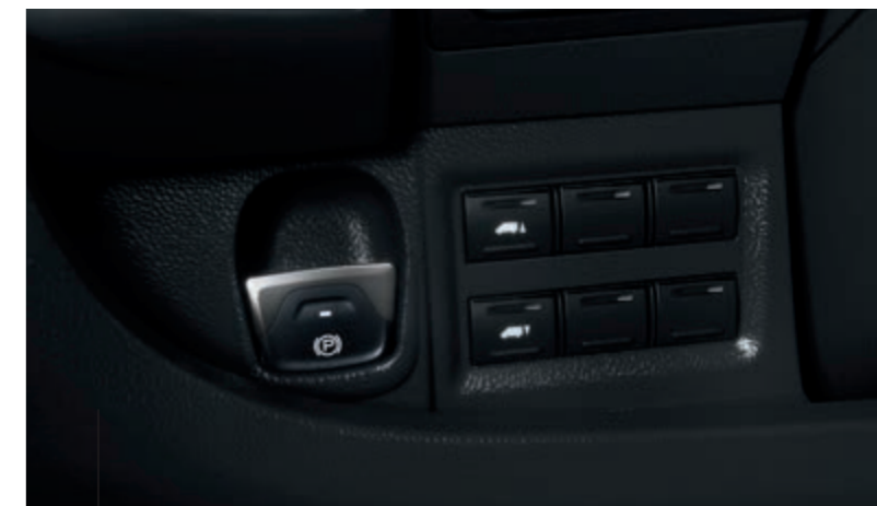
Ein sauberes Fahrzeug-Layout frei von Handbremshebel, Halterung und Kabeln. Die neue Option der elektrischen Parkbremse sorgt für mehr Komfort im Alltag.
