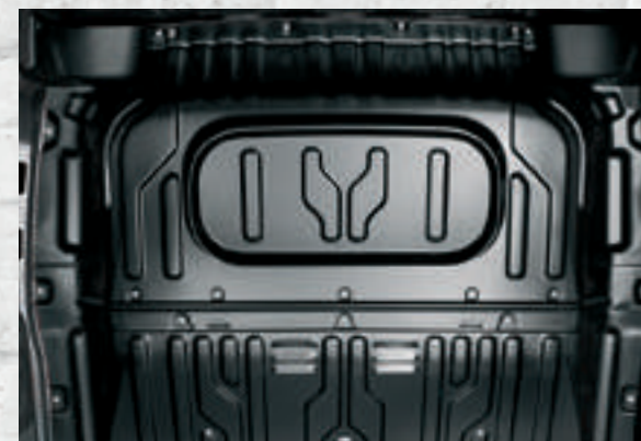
Trennwand ohne Fenster
