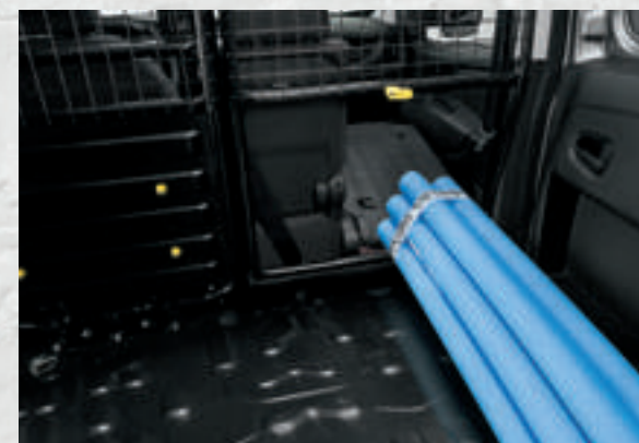
Multifunktionales Trenngitter für 3-Sitzerkonfiguration, für lange Gegenstände auf der Beifahrerseite abnehmbar
